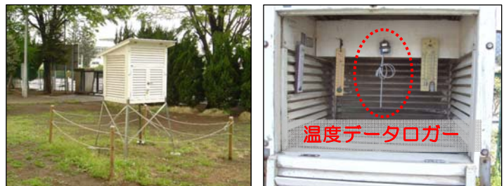
写真 1. 小学校の百葉箱と温度データロガーの設置例
