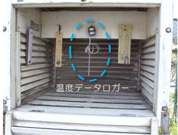
図 5 小学校の百葉箱と温度データロガーの設置状況
