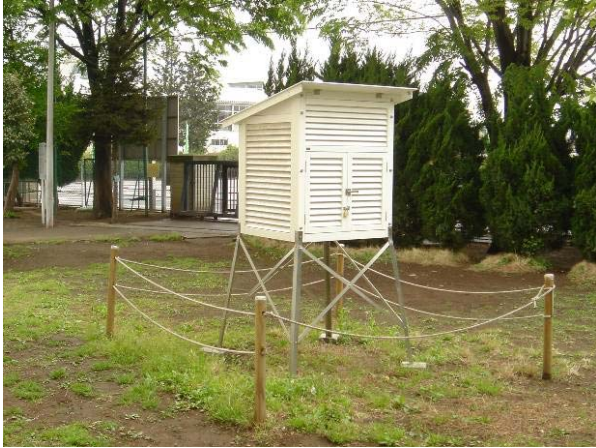
図 5 小学校の百葉箱と温度データロガーの設置状況
